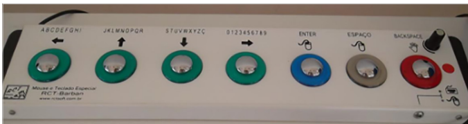
Figura 21 Mouse e teclado RCT (substitui o uso do teclado e do mouse, funciona com o toque de qualquer parte da pele do usuário e não precisa de pressão).
