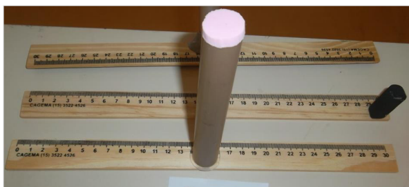
Figura 16 Réguas em madeira adaptadas com cabo em PVC, EVA e epóxi com mangueira de chuveiro.
