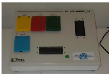
Figura 19 Roller Mouse (substitui o mouse convencional, e as funções/botões poderão ser acionados com mãos ou pés).
