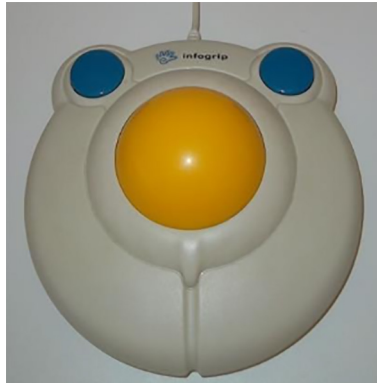
Figura 20 BigTrack (substitui a função do mouse, facilitando seu manuseio).
