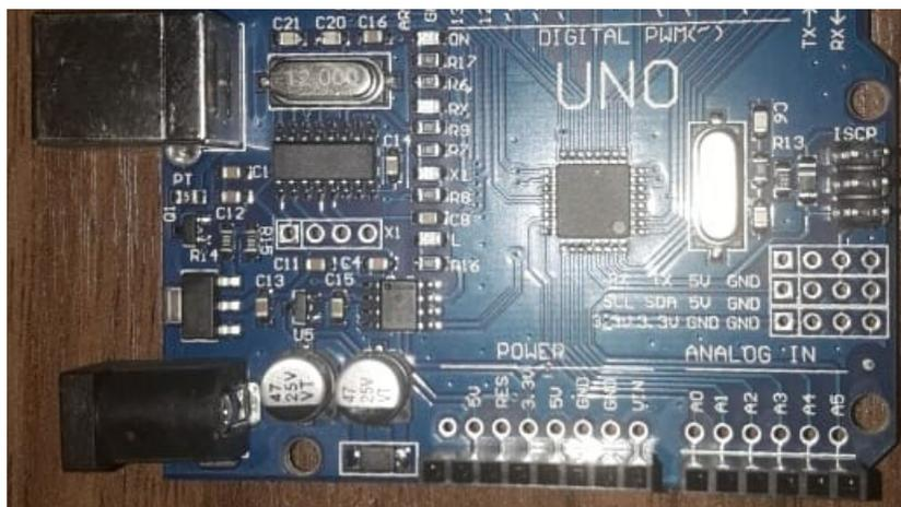
Figura 1.8 – Arduino Uno. Fonte: Dos autores.
