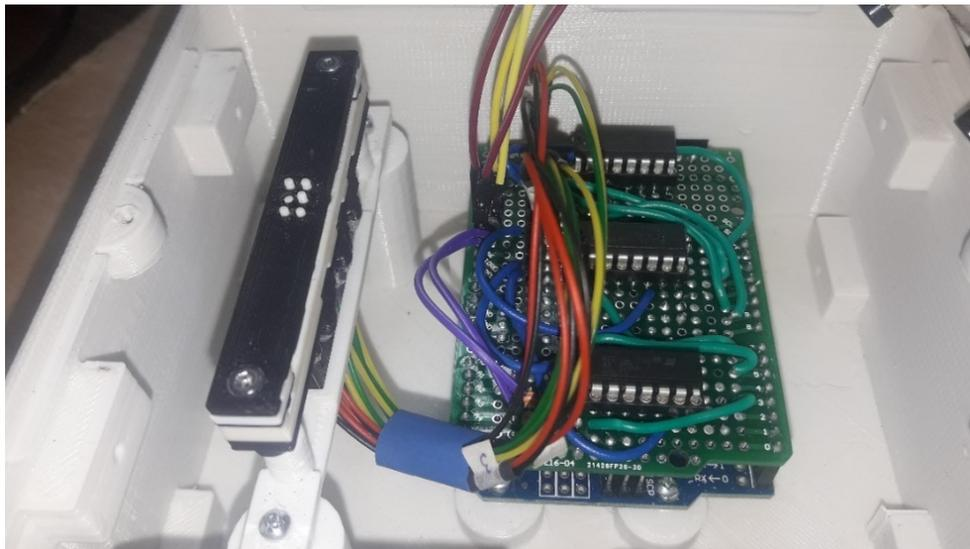
Figura 3.106 – Como conectar a placa ilhada ao Arduino.
