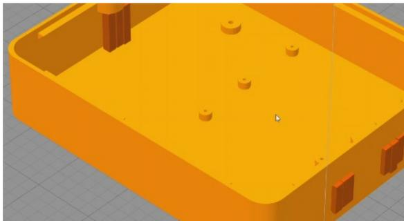
Figura 3.41 – Simplify3D: visão com os suportes manuais suficientes.
