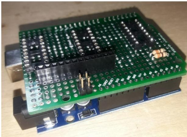
Figura 3.61 – Arduino disposto como guia para a soldagem.
