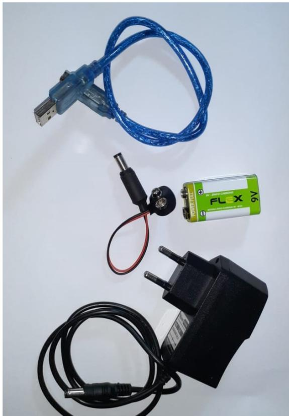
Figura 1.11 – Alimentação para o Arduino. Fonte: Dos autores.
