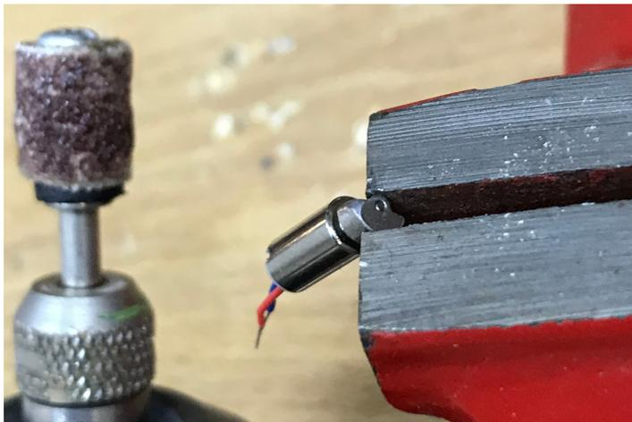
Figura 3.92 – Detalhe da cabeça giratória de um motor com uma das bordas desbastadas com a retífica (Dremel).
