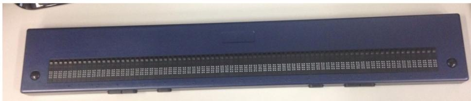
Figura 1.14 – Display braille. Fonte: Dos autores.
