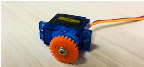
Figura 1.23 – Servo e motor com engrenagem para a abordagem 5.
