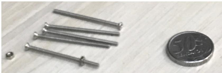
Figura 3.99 – Parafusos compridos com porca.
