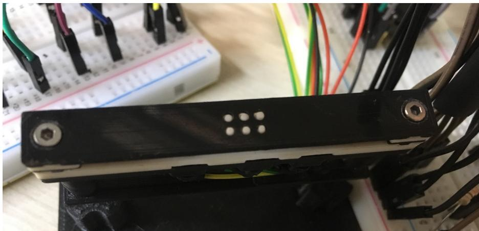
Figura 1.24 – Protótipo desenvolvido de uma célula braille de 6 pontos, em tamanho padrão e já funcional. Fonte: Dos autores.
