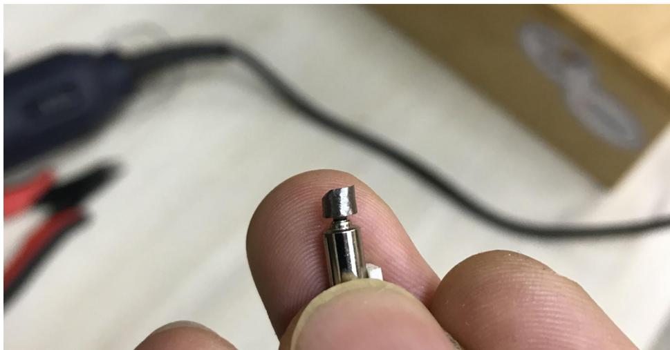
Figura 3.93 – Detalhe da cabeça giratória de um motor com uma das bordas desbastadas.
