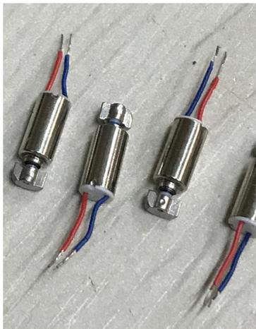
Figura 3.94 – Vários motores já com um dos lados da cabeça desbastados.
