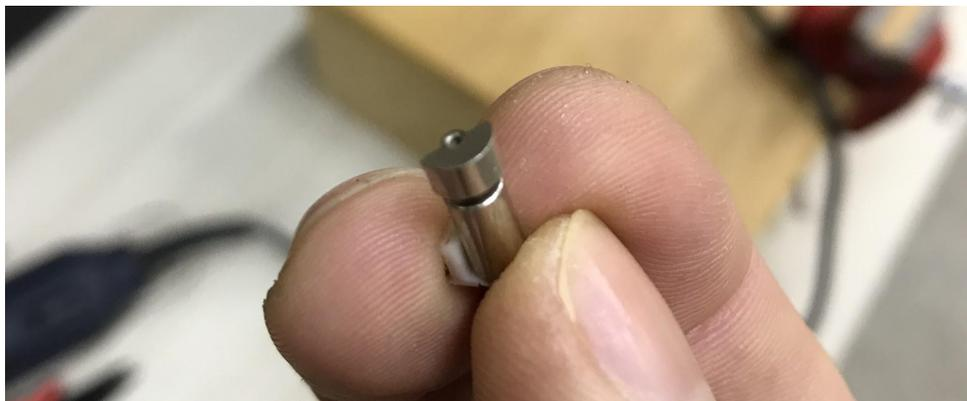
Figura 3.91 – Detalhe da cabeça giratória de um motor com as bordas originais.
