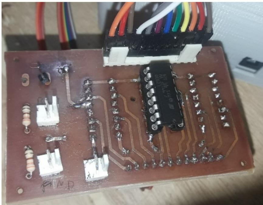
Figura 3.110 – Conectando os cabos das portas digitais.
