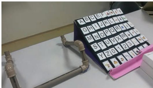
Figura 5 Plano inclinado de PVC para notebook e Plano inclinado com letras e figuras com fixação em velcro.
